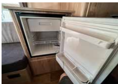
Vestavěná kompresorová chladnička s vyjímatelným mrazákem.
