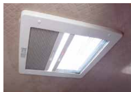
Střešní okno s ventilací, sítkou a zatemněním.
